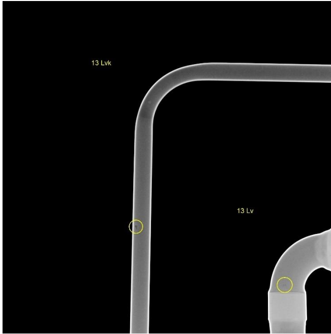
KUVA 26. LVK ja LV. Pistesyöpymiä. KL4.
